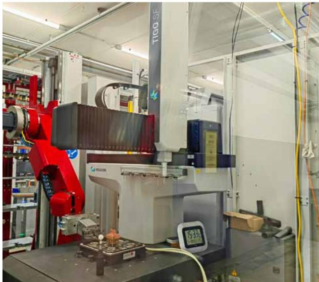
精度必须是可记录的：海克斯康三坐标测量机的精度达到 1 微米。在装载过程中，尽管占地面积最小，但线性机器人展示出了其出色的伸展范围。
