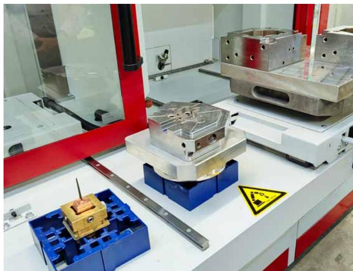
带有零点夹紧系统和各种适配器的 Erowa 托盘是获得极其精确加工结果的可靠基础 (图片: Klaus Vollrath)
