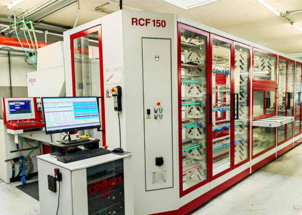
新的生产线。独立的罗德斯作业管理系统RMSMain位于左手边，工具和托盘架在玻璃门后面。加工设备在对面排成一行（照片：Klaus Vollrath）
