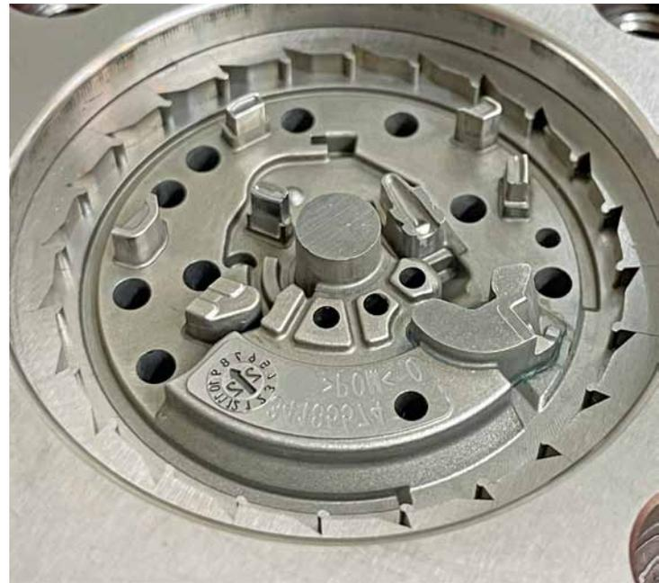
用于汽车皮带张紧器系统的复杂塑料齿轮的模具镶件。对于这个安全部件，成品部件的表面轮廓公差仅为40微米。该模具有8个型腔（照片：SFS）
